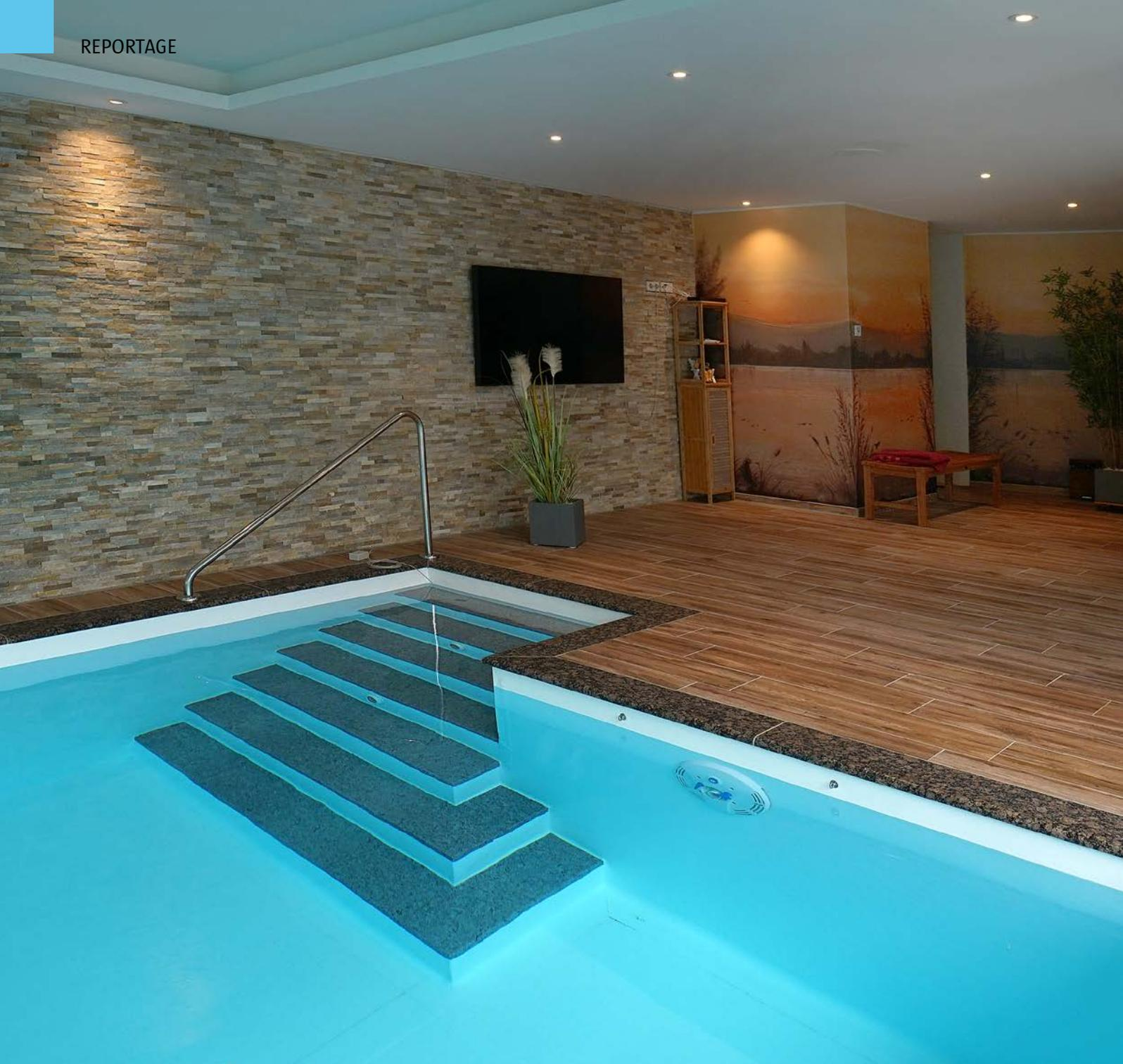
Das Schwimmbecken verfügt über eine auskragende Treppenanlage – einmal aus optischen Gründen, zum anderen sollte durch die Treppe keine Schwimmfläche verloren gehen. Eine an die Form der Beckenanlage angepasste Rolladenabdeckung deckt die lange Wasserfläche komplett ab.
